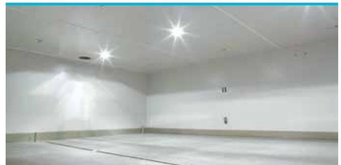
Conçu pour grandes chambres froides, entrepôts frigorifiques, salles de travail et même petites chambres froides avec formes irrégulières. Mousse rigide de polyuréthane sans CFC et HCFC. Panneau Bs2d0. Tôle d'acier légèrement nervuré, galvanisé et prélaqué polyester avec un film de protection pelable. Marcado CE.
