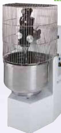
Carrosserie en inox peint. Ustensile, spatule, cuve et grille de protection en inox. Bandeau de commande sur face droite. Transmission par courroie. Hauteur du bras droit réglable. Engrenages dans bain d'huile. Alimentation 400 V tri.
