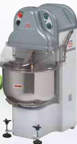
Pièces de travail montées sur roulements à billes. Mouvement des bras réalisé par engrenages en nylon autolubrifiant à faible niveau sonore. Bras de pétrissage et bol en acier inoxydable AISI 304. Minuterie. Mélangeur équipé de roues pour le mouvement et de deux pieds stabilisateurs.
